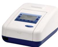
Lo spettrofotometro consente di effettuare analisi fotometriche in campo UV e visibile, ha funzioni di misura di assorbanza, trasmittanza e concentrazione.
